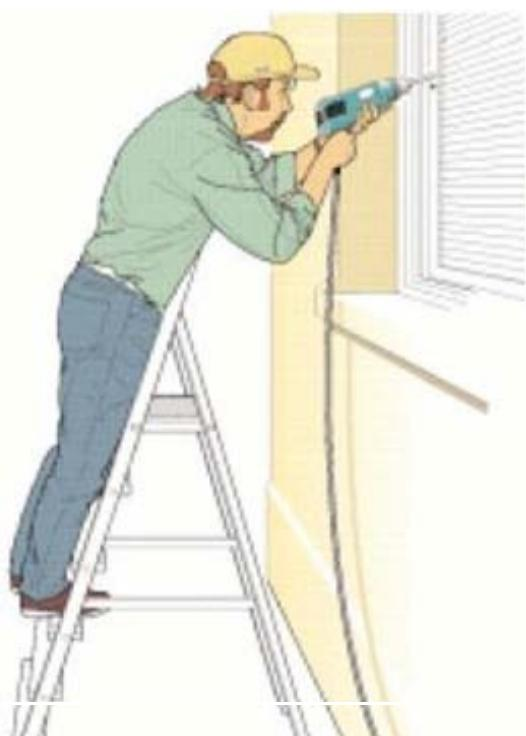
شکل ۱۰- استقرار صحیح برای کار
